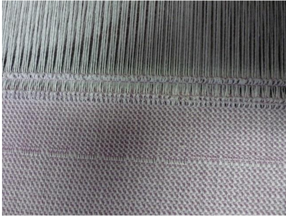
パイルが生まれる瞬間をクローズアップして撮った写真。
