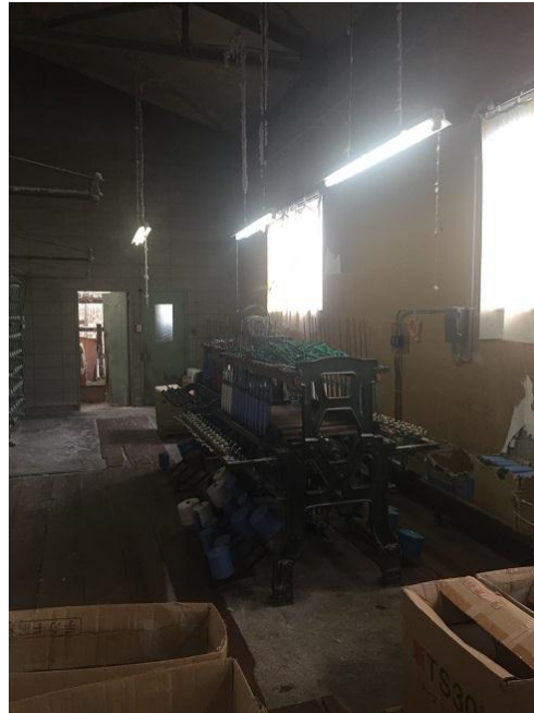
村秀鉄工所製のシャトル織機（左）と緯糸用の ポビン巻機（右）。
