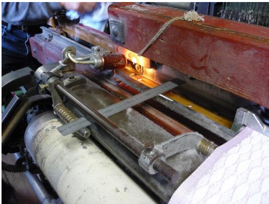
ソウドウウチでタオルが製織されている様子。
