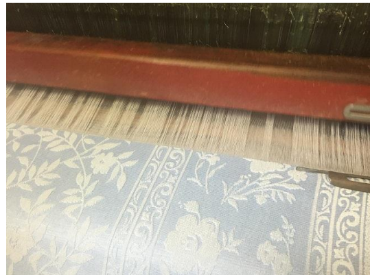
ソウドウウチでタオルが製織されている様子。
