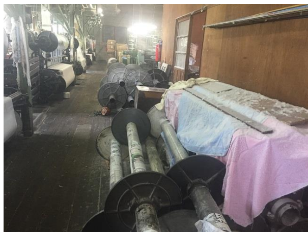
ジャカード織機用の経糸を巻く前のビーム。
