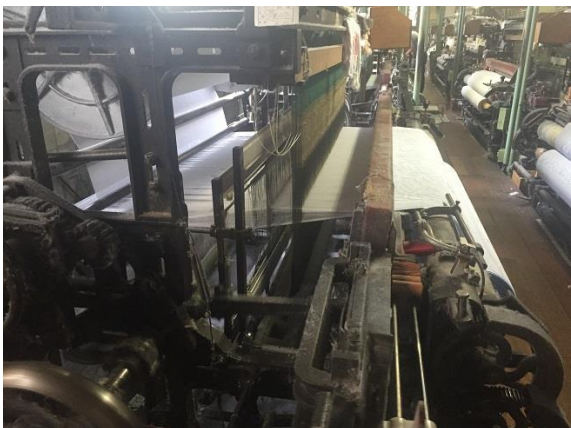
ミナトタオルの工場内には12台の村秀鉄工所製のシャトル織機が設置してある。
