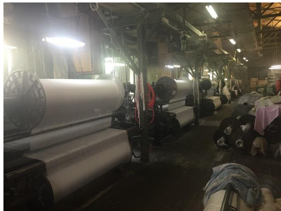
ミナトタオルの工場内には12台の村秀鉄工所製のシャトル織機が設置してある。
