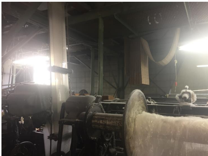
パンチカードを使って旧式のジャカード織機でタオルを製織
