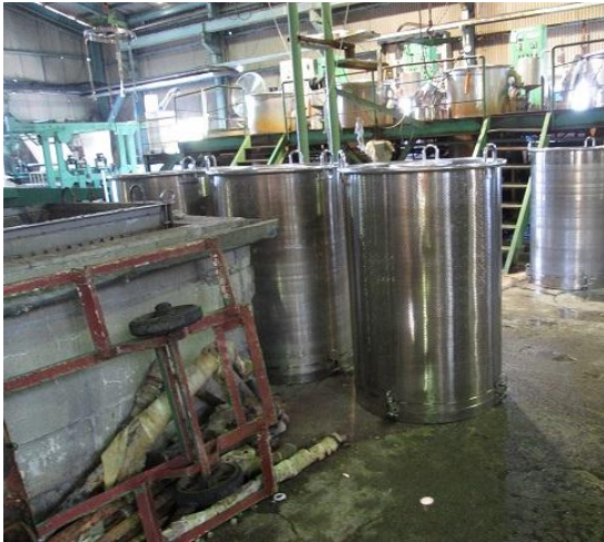
染色用大型釜に入れるステンレス製バスケット
