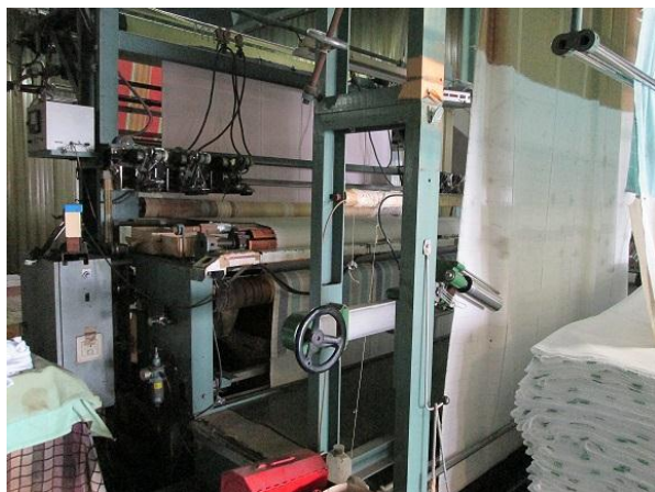
スリッターで用途に合わせてタオル生地を裁断する
