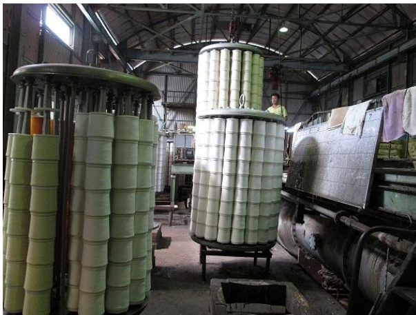
クレーンでチーズキャリアーを大型釜に挿入
