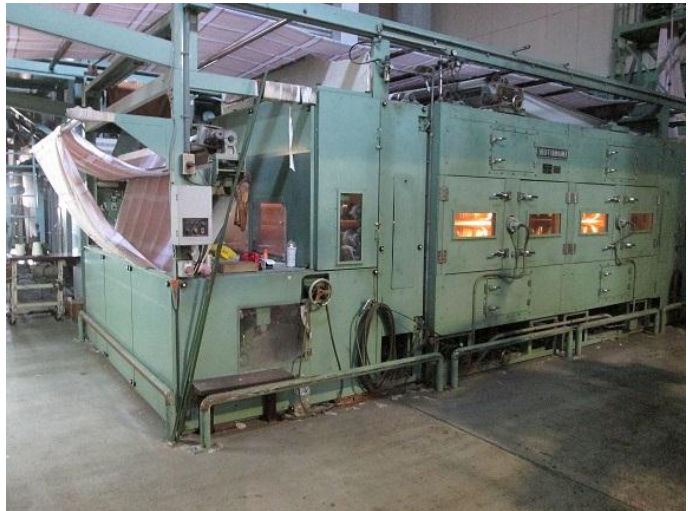
壽工業(株)製のランダム乾燥機でタオル生地を乾燥させる
