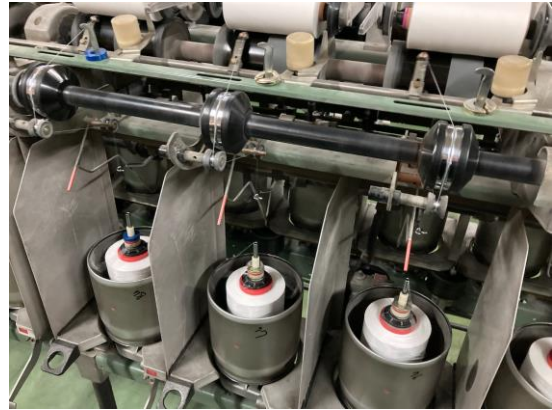
砂田 燃系（株）の工場に設置されている合糸機とダブルツイスター
