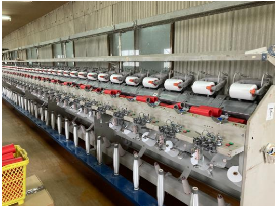
砂田 燃系（株）の工場に設置されている合糸機とダブルツイスター
