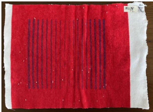
顔料を使って青色のボーダー柄を出す実験において、酒石酸（ヒドロキシ酸）0%の場合（左）は青色のボーダー柄が浮かび上がらないが、酒石酸3%を含有した場合（右）は鮮明な青色のボーダー柄が浮き出る
