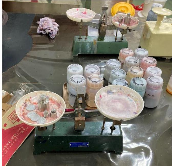
染料は粉末、顔料は液体の状態で、写真のような容器に入っている
