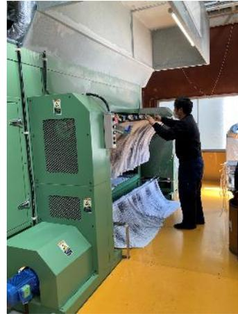
染料プリントされたタオルを専用の道具を使って一枚一枚手作業で取り上げ、
