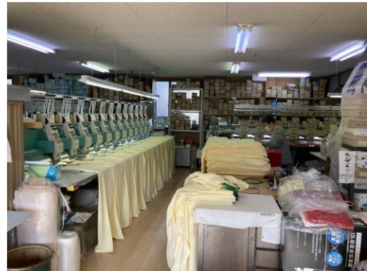
12基がワンセットになった工業用多頭式刺繍機を使って
