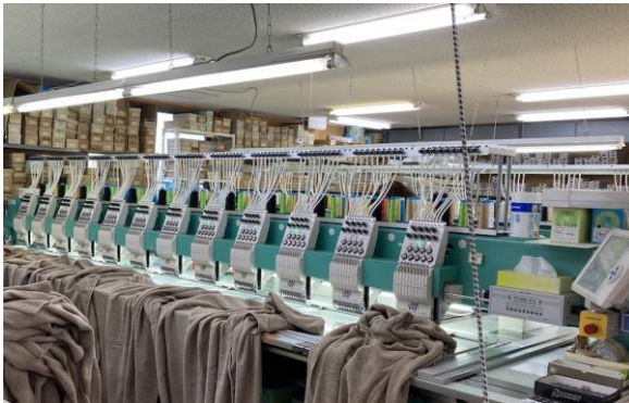
12基がワンセットになった工業用多頭式刺繍機を使って
