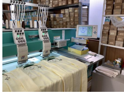
型をコンピュータに読み込ませ、 自動で刺繍加工する
