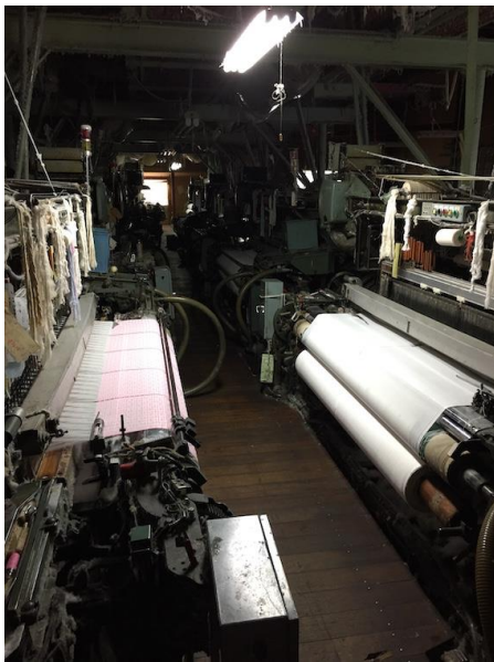
工場内には、織機（左）や整経機（右）などが設置されている
