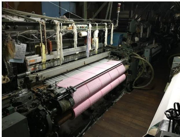
さまざまな製品を生み出し大切に保全されてきた豊田式自動織機
